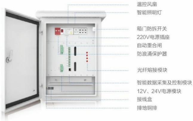
图 1-1 设备箱内部模块实物图
